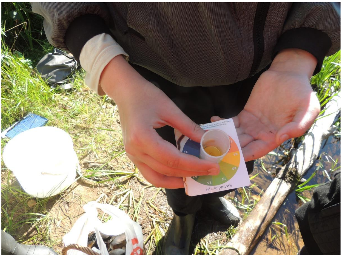
Рис. 8. Определение гидрохимических показателей с помощью тестов НИЛПА. Водородный показатель (рН) воды из реки Пейпия
